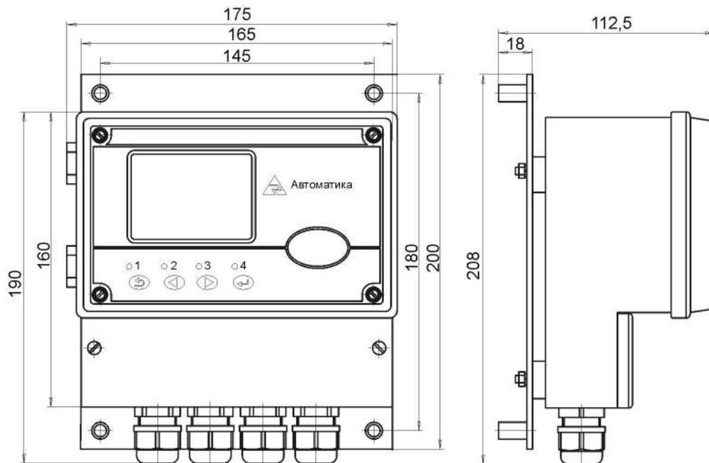
Рисунок А.3 - Корпус измерительного прибора настенного исполнения
