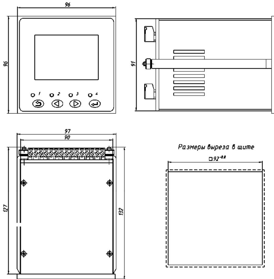
Рисунок А.2 - Корпус измерительного прибора щитового исполнения
