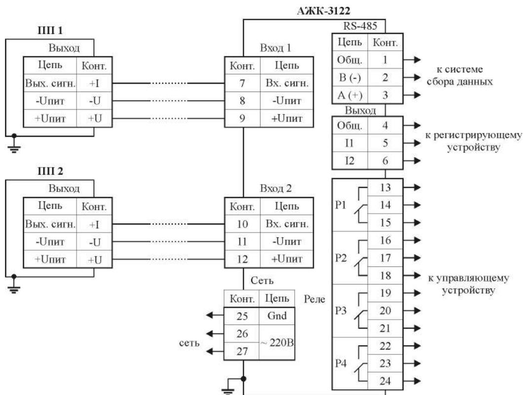
Рисунок В.2 - Схема внешних соединений для ИП настенного исполнения
