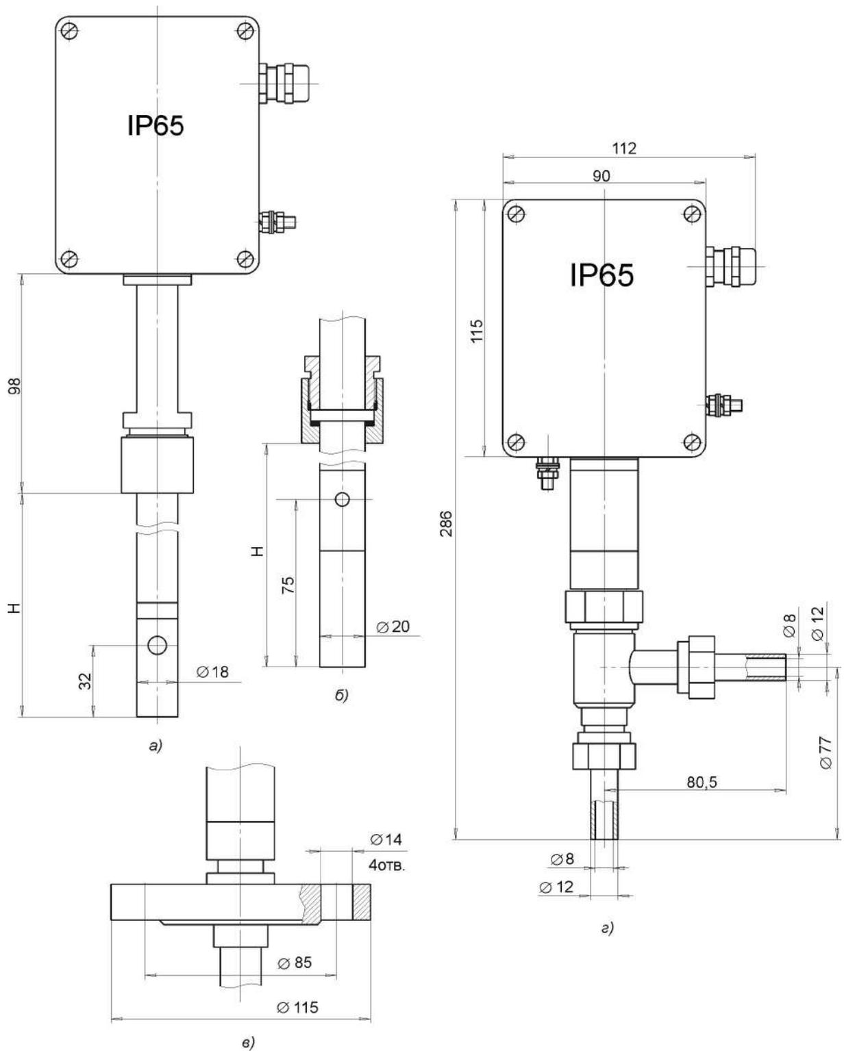
Рисунок А.1 – Габаритные и монтажные размеры первичных преобразователей: а) - погружного для АЖК-3122.1 с бобышкой и корпусом электронного блока «Д»; б) - то же для АЖК-3122.2; в) - то же с фланцем; г) - проточного для АЖК-3122.1; д) - проточного для АЖК-3122.2; е) - с корпусом электронного блока «Н»; ж) - с корпусом электронного блока «И»
